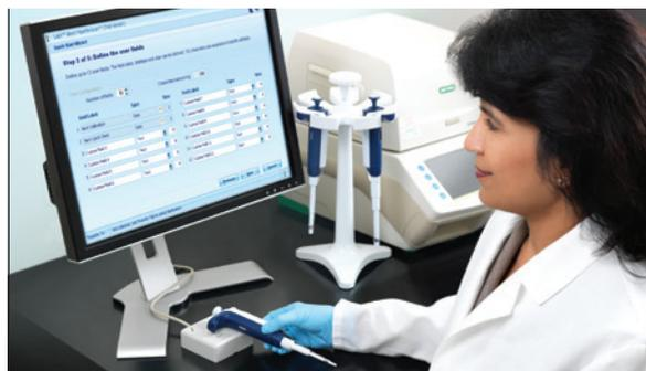
El lector RFID opcional funciona con todas las pipetas de Rainin con RFID e interactúa con el software de comprobación de calibración LabX™ Direct Pipette-Scan™ de METTLER TOLEDO.
